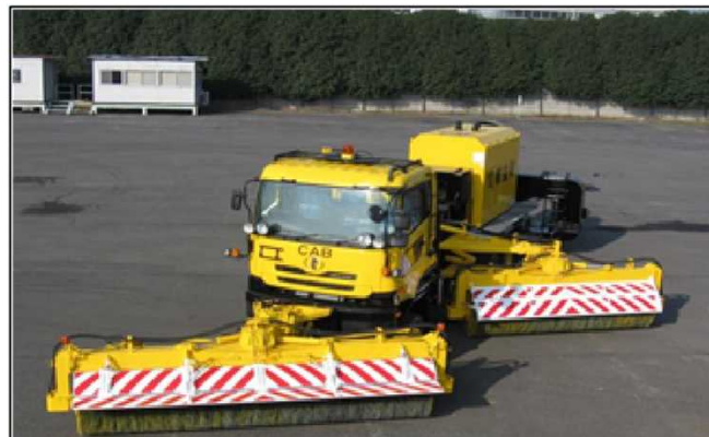
【スーパー除雪車】 高速で回転するブラシと強力送風機(ブロー)によって路面上の雪を掃き飛ばす除雪車
