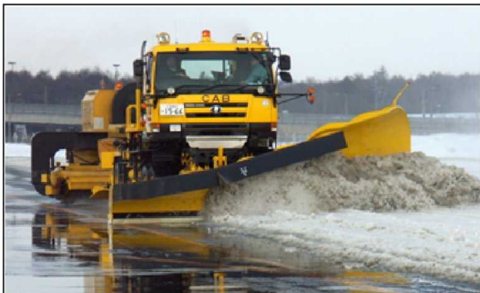
【プラウ除雪車】 路面の雪を押しだして移動させる機材
