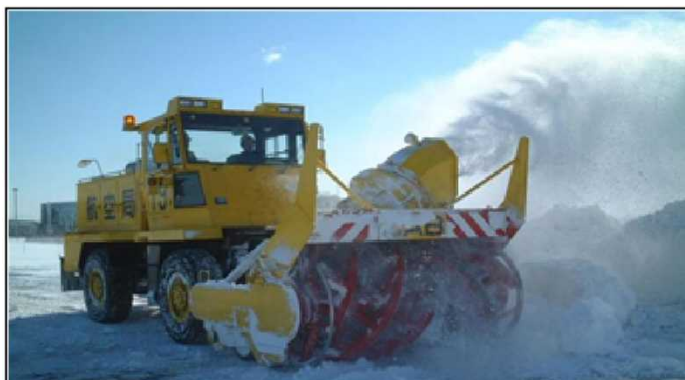
【ロータリー除雪車】 前面のオーガで雪を崩してかきこみ、上に突き出しているシュートから雪を吹き飛ばす除雪車
