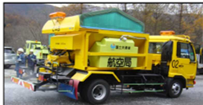
【凍結防止剤散布車】 除氷または防水作業で滑走路、誘導路に凍結防止剤を散布する車両
