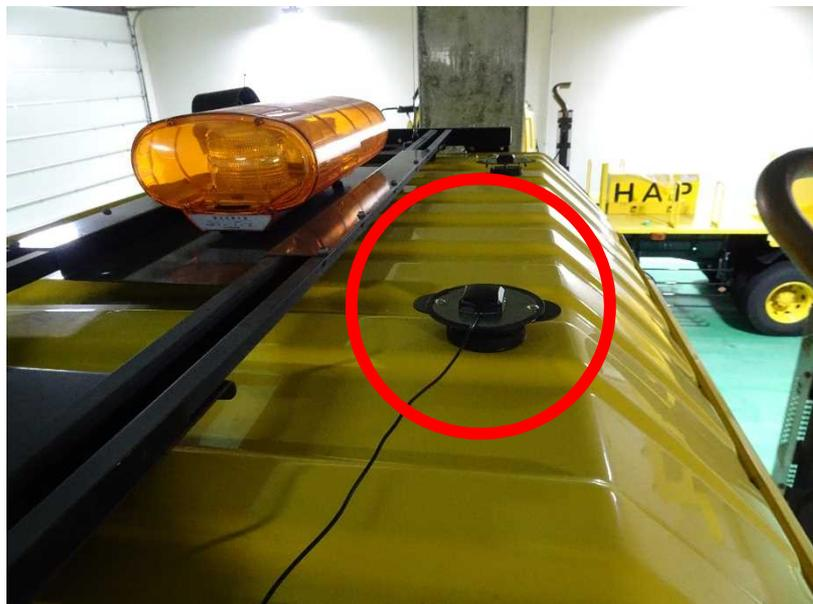
車両上部GNSSアンテナ写真
