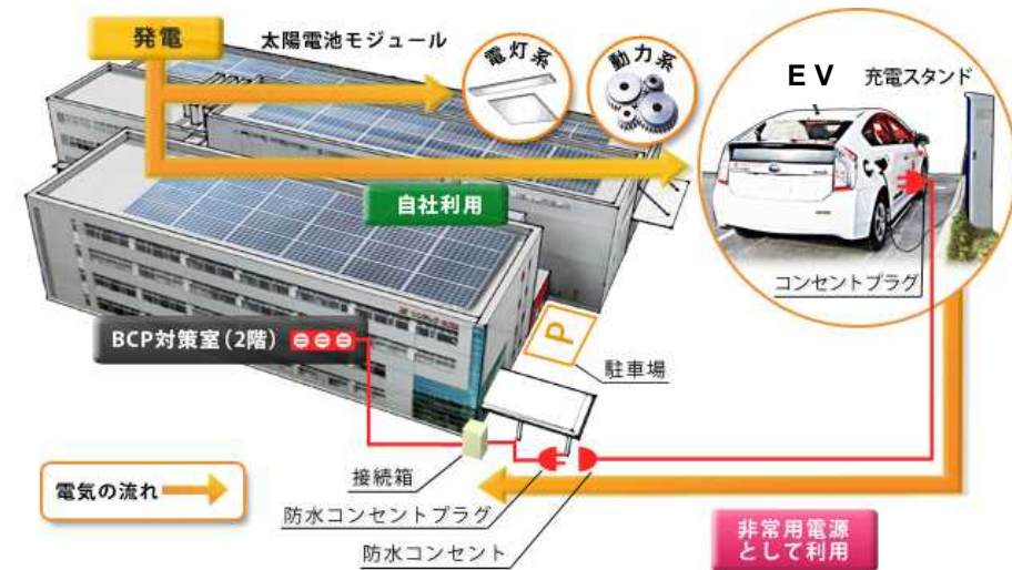
太陽光エネルギーを利用した、EV車向け充電システム
