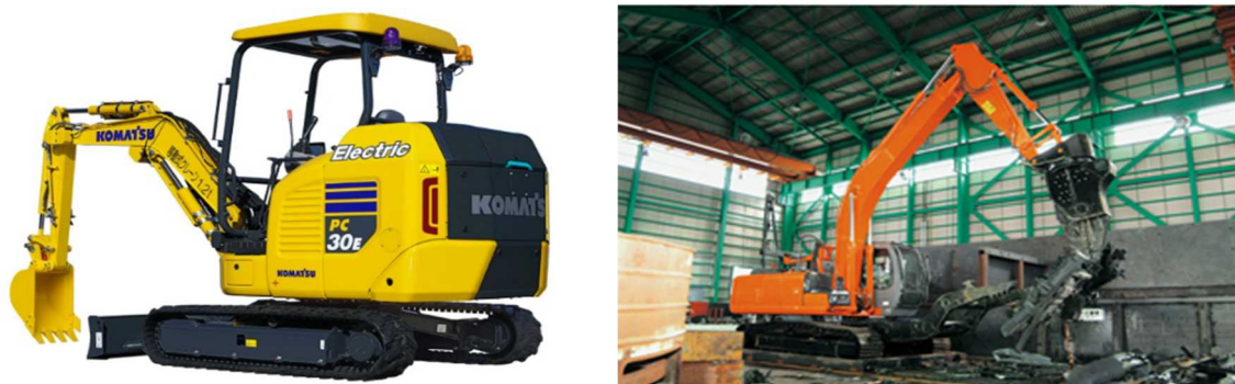
図 4.2.2 工事車両の電動化
