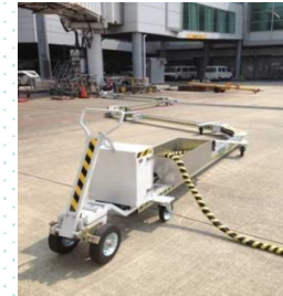
電源ケーブル用収納箱
