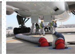
エアコン供給の様子
