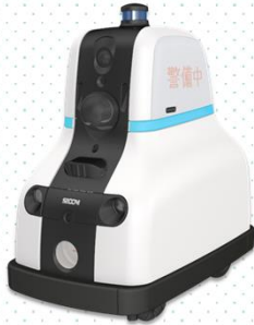
《オプション装備》 センサーアーム、ヘッドライト（威嚇・カメラ照明）、発煙装置
