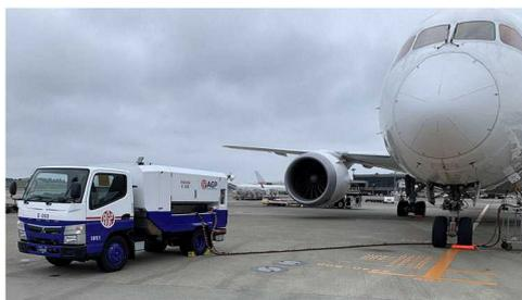
写真 5.1.1 移動式 GPU(自走・発電方式)
