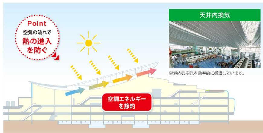
図 5.7 天井換気システム
