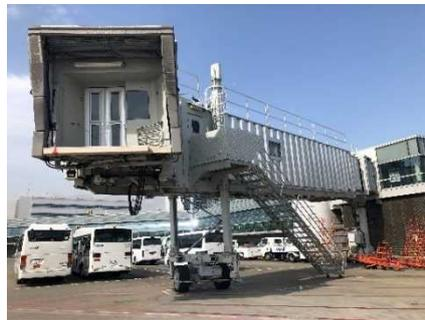
図 3.2.15 放射冷却素材を用いたフィルムを施工された PBB
