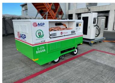
写真 5.1.2 移動式 GPU(牽引・バッテリー駆動式)
