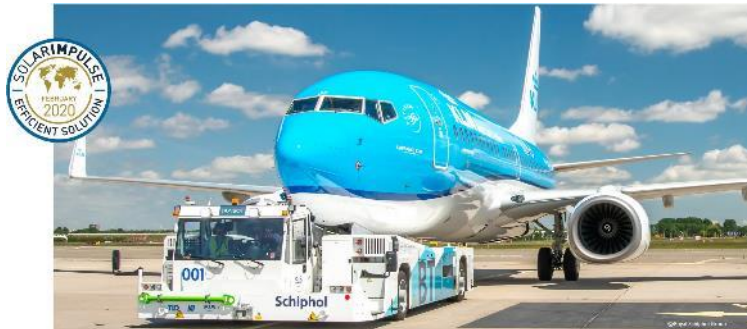
図 5-11 TaxiBot による航空機牽引イメージ
