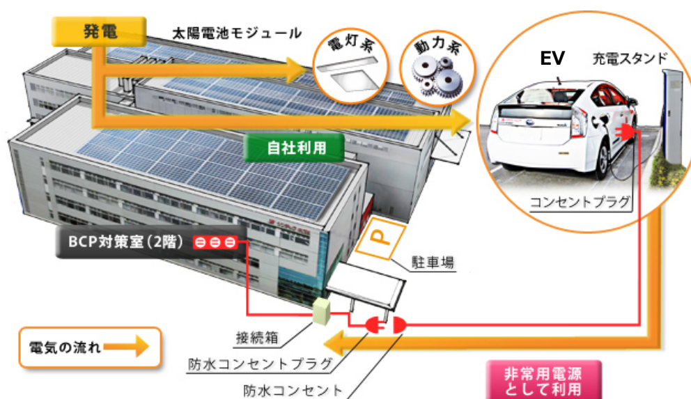
図 5.2.1 太陽光エネルギーを利用した EV 車向け充電システム
