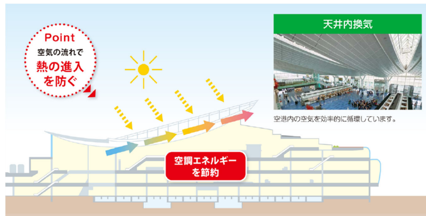
図 5.7 天井換気システム
