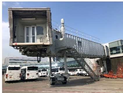
図 3.2.15 放射冷却素材を用いたフィルムを施工された PBB
