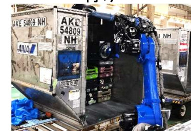
手荷物の自動積み 付け
