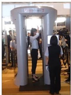
現行の接触検査に代わるものとして、自動的に非接触で人体表面の異物を検知する装置
