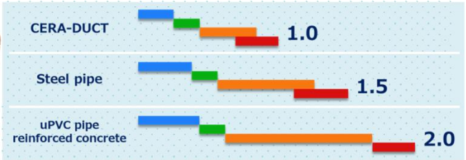
■ : Excavation ■ : Ground Leveling ■ : Duct Installation ■ : Backfilling
