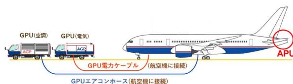
図 3 移動式 GPU（電力・空調）
