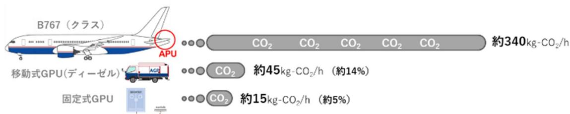
図 4 GPU（電力）の CO<sub>2</sub> 削減比
