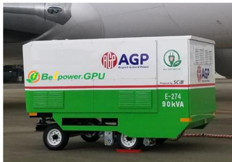
バッテリー駆動式 GPU 「Be power. GPU」
