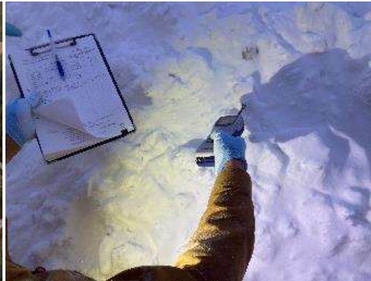
▲雪提の硬度計測状況
