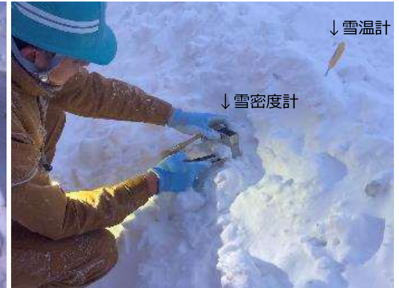
▲雪密度計と雪温度計による計測状況
