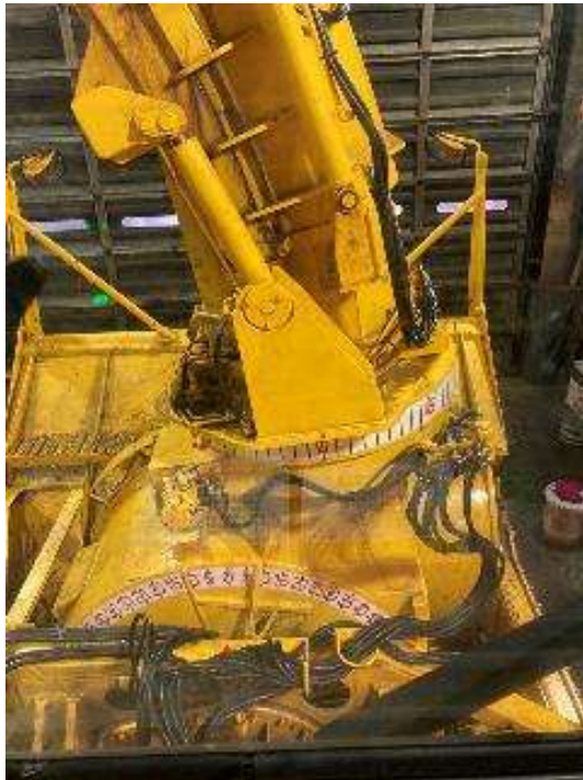
▲シュートへの目盛取付状況
