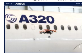
ドローンを使用した機体点検
