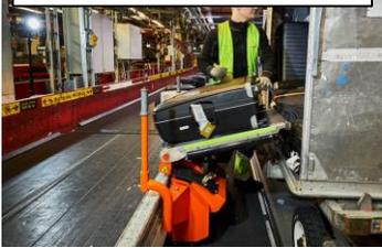
到着手荷物を返却ベルトへ流す作業を機械がアシストすることで、省力化と作業早期化
