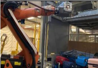
出発手荷物を機械が自動的にコンテナに積み付けることで、積み付け作業の省人省力化
