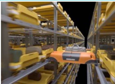
次世代の手荷物搬送設備（EBS、BHSへの自律走行ロボットの適用、バルクBHS）
