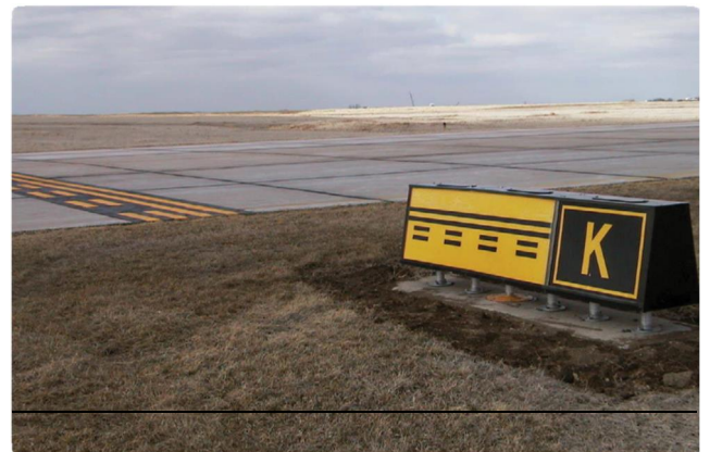
図 14-8. 滑走路Kiloにある滑走路安全区域の境界標識と標示。
