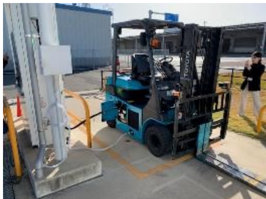
貨物地区 水素エネルギー活用 (2018年11月導入)
