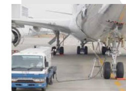
充電、圧縮空気・冷暖房 の供給、給水
