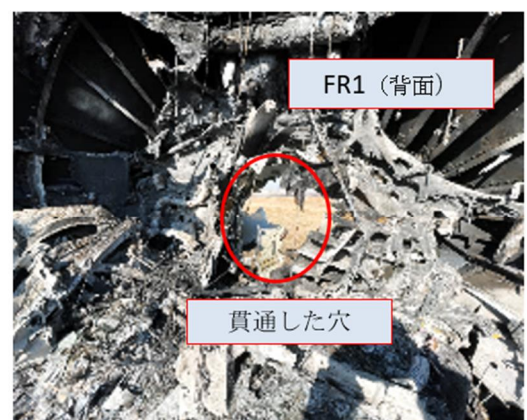
図 3 4 - 6 B機の機首部分（内部）
