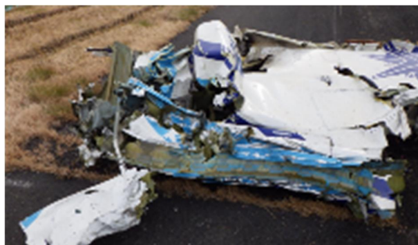
図 3 1－2 A機 垂直尾翼（詳細）
