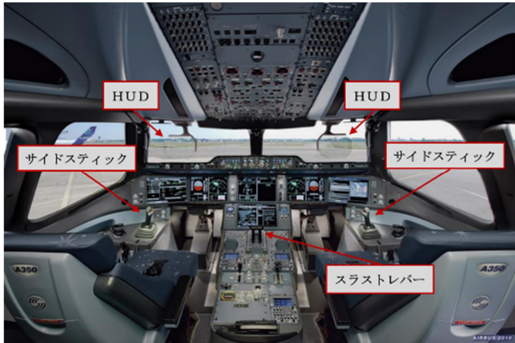
図13-1 B機同型機の操縦室 (エアバス社提供図に加筆)
