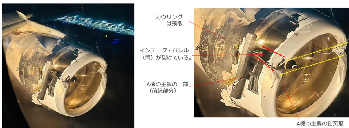
図 4 6 - 2 損傷を受けた衝突直後の左エンジン（乗客提供）
