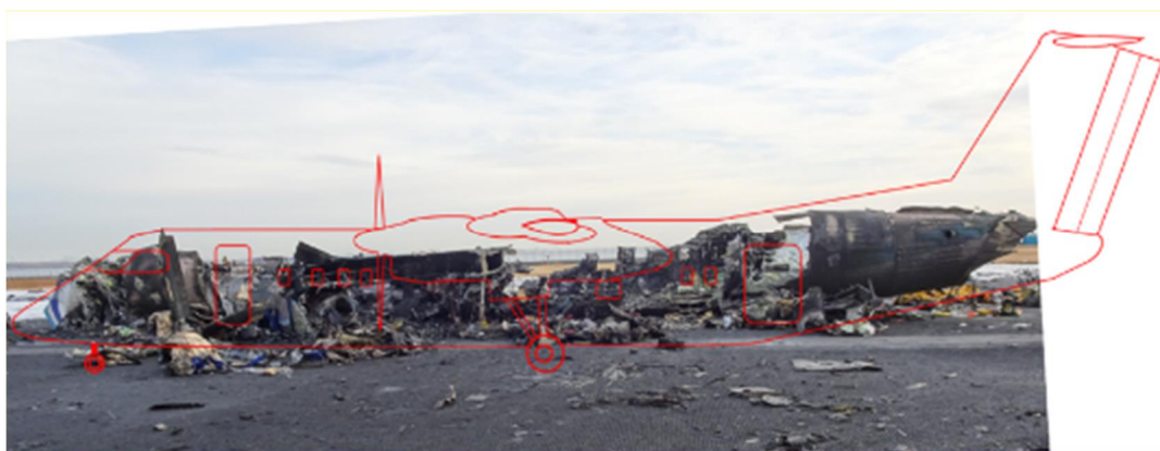
図 3 0－1 A機の損壊状況図
