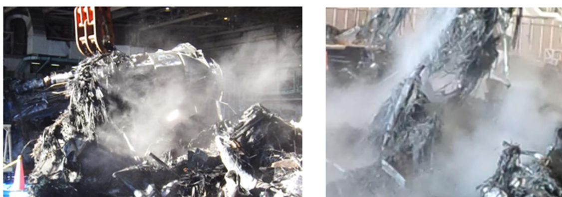
図 3 4 - 2 CFRP 焼損後の粉塵の状況
