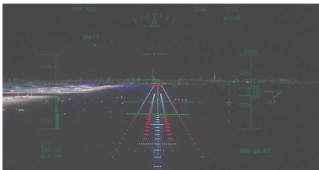
図 5 5 - 1 HUDを通じて見た滑走路 3 4 R (シミュレーター検証時撮影)
