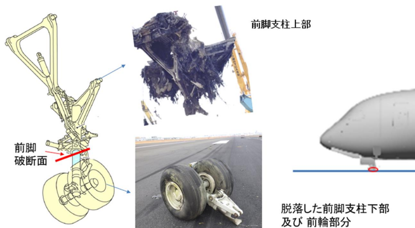
図 4 0 - 6 折損した前脚 （エアバス社提供図に加筆）
