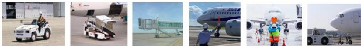
① トーイングトラクター ② ベルトローダー ③ 旅客搭乗橋 ④ 安全監視・駐機 ⑤ 航空機誘導 ⑥ プッシュバック / ⑦ トーイング
