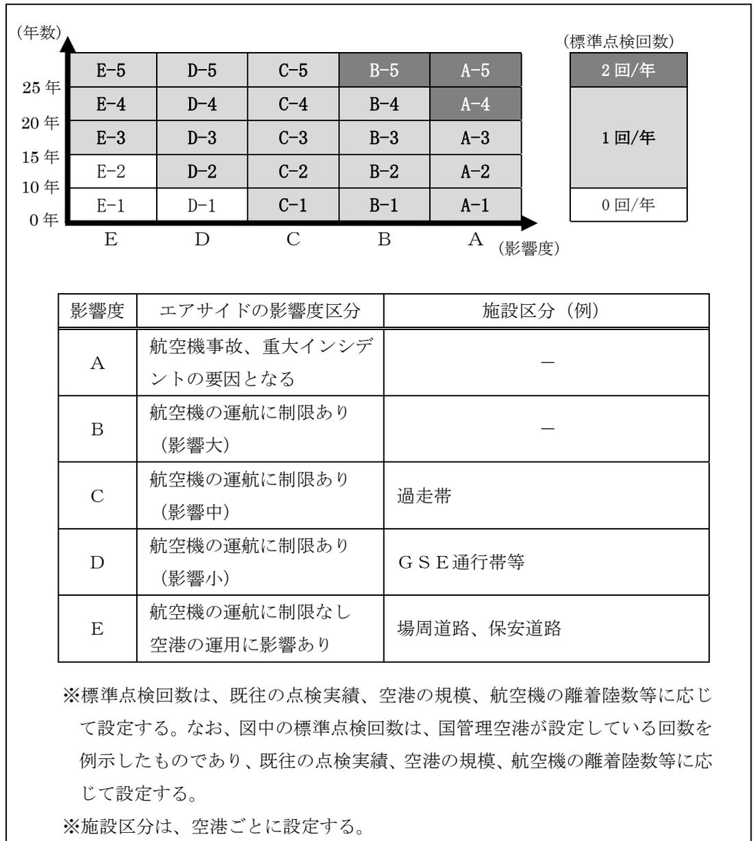
図 4.2.3 基本施設以外（制限区域）の巡回点検の標準点検回数の設定（例）
