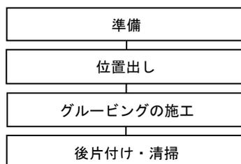
図 5.1.4 再グルーピング工の施工フロー (例)
