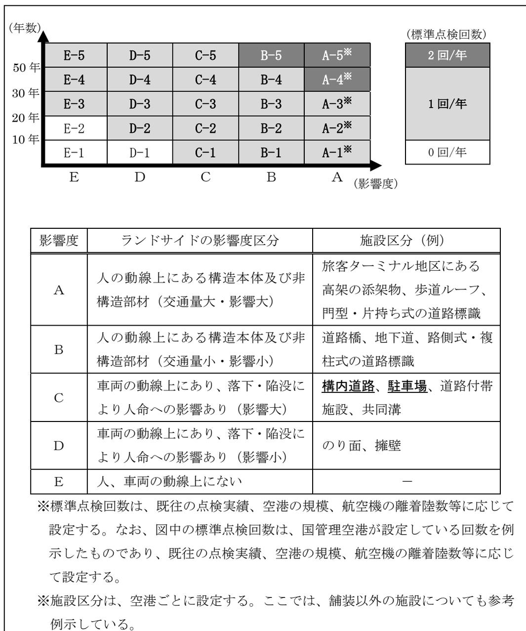
図 4.2.4 基本施設以外（制限区域外）の巡回点検の標準点検回数の設定
