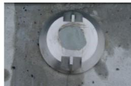
写真 2-1 電位測定端子
