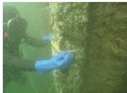
写真 2-3 陽極の形状寸法測定状況
