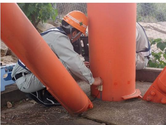
トレスル橋脚 非破壊試験状況
