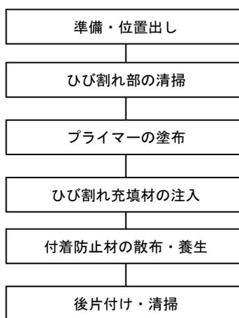
図 5.1.1 ひび割れ注入工の施工フロー (例)
