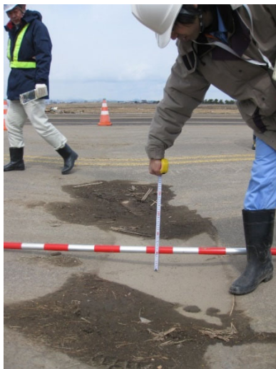
写真－２． １ 【基礎地盤の液状化による局所沈下】の測定例 (左は沈下幅に対してポールが足りておらず、実際の凹み量はもっと大きい) (右は沈下幅に対して十分な長さのスタッフを使用している)
