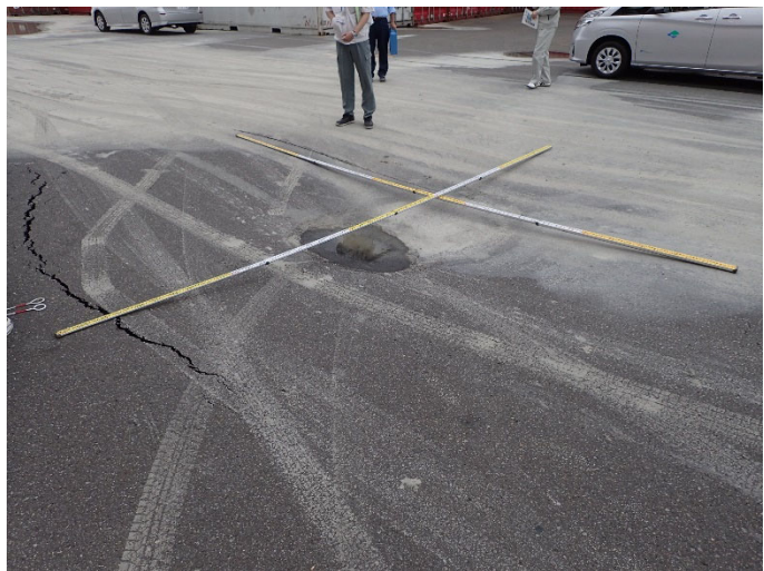
写真－２． １ 【基礎地盤の液状化による局所沈下】の測定例 (左は沈下幅に対してポールが足りておらず、実際の凹み量はもっと大きい) (右は沈下幅に対して十分な長さのスタッフを使用している)
