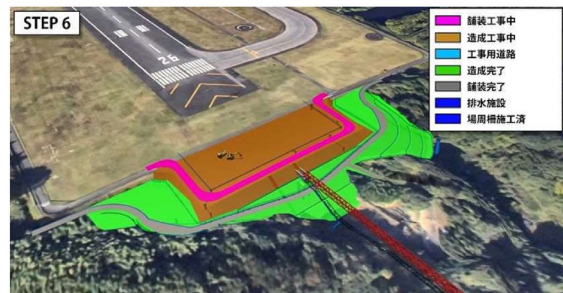
STEP6: 造成・舗装・排水工事
