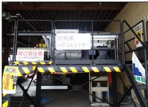
As合材再加熱用アスファルトミキサー
