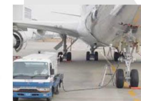
充電、圧縮空気・冷暖房 の供給、給水
