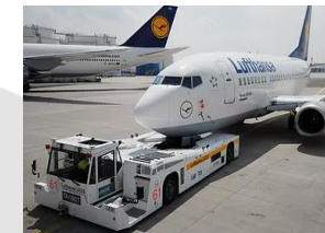
航空機トーイング (車両等を用いて航空機 を牽引すること)
