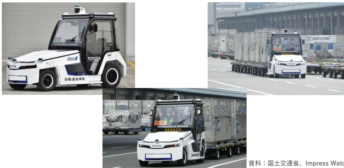
また、AiRO 社も自動運転トローイングトラクターを使用し、羽田空港の制限区域内で自動走行の実現に向けた実証実験を実施しました。
