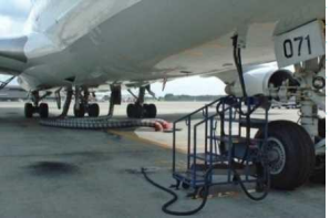
電力供給の様子
