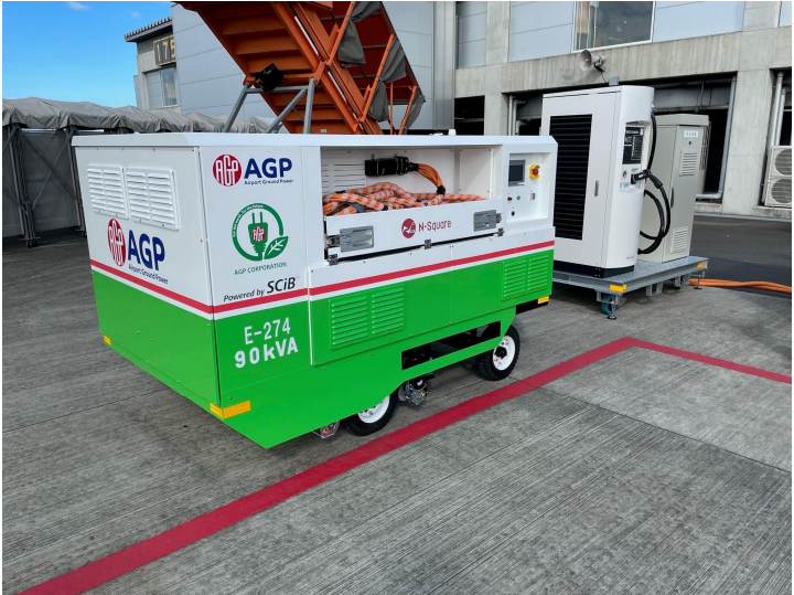
バッテリー駆動式GPU 寸法 L2,745×W1,480×H1,620mm 重量 2,200kg以下
