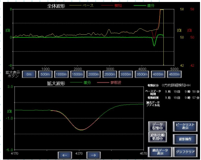
漏洩検知ケーブル監視画面
