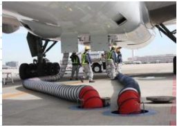
エアコン供給の様子
