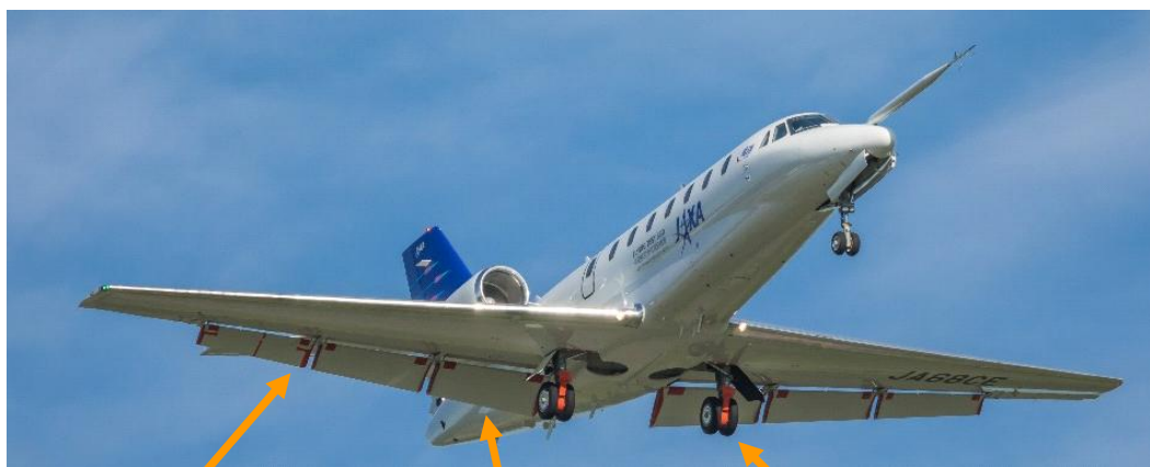
フラップとスラットを改造した状態のJAXA実験用航空機「飛翔」
