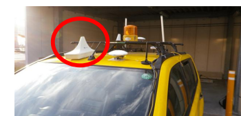
滑走路に進入する車両に位置情報等送信機を搭載
