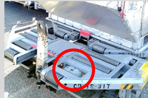
▲ドローリのローラーを1本外して取り付け窓にアンテナを貼り、基地局を簡易設置▶
