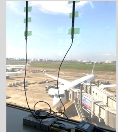
▲ドローリのローラーを1本外して取り付け窓にアンテナを貼り、基地局を簡易設置▶
