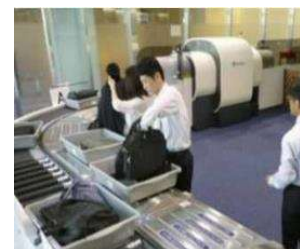
「スマートレーン・X線検査機器」
