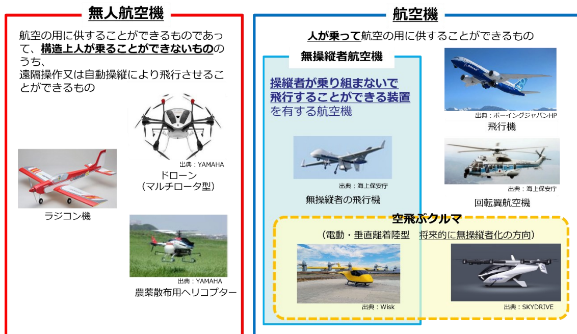
図1：航空法上の航空機の種類と適用範囲
