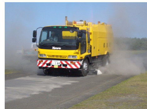
降灰対策型路面清掃車の清掃状況
