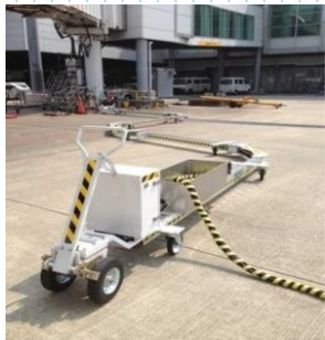
電源ケーブル用収納箱
