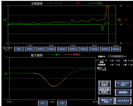
漏洩検知ケーブル監視画面
