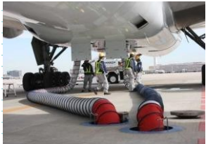
エアコン供給の様子
