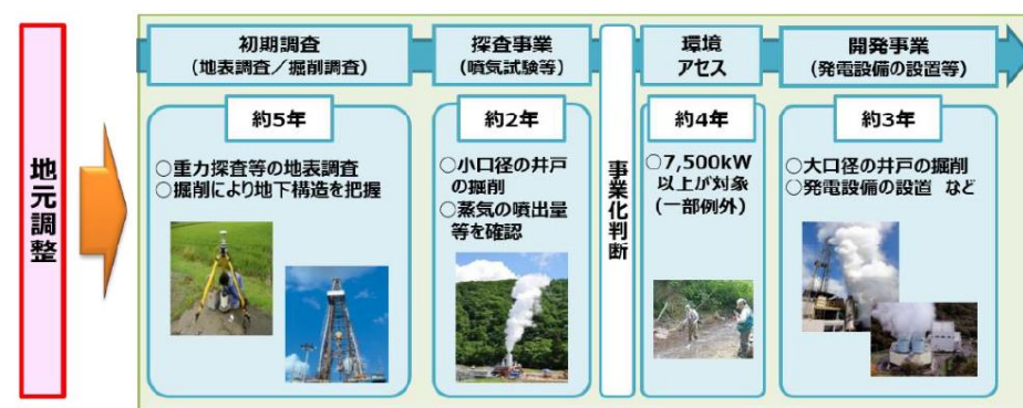
図 4-47 地熱発電事業の開発プロセス
