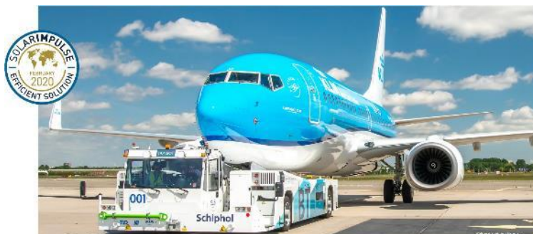
図 5-11 TaxiBot による航空機牽引イメージ
