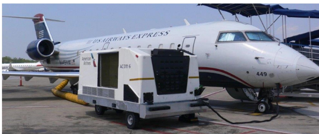
図 5-6 航空機に接続するコンボ型の移動式 GPU
