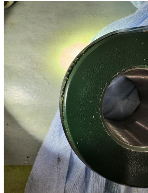
Figure 2 – Fissure dans le revêtement d'uréthane du faisceau torsible d'Airwolf installé sur un hélicoptère Bell 206B
