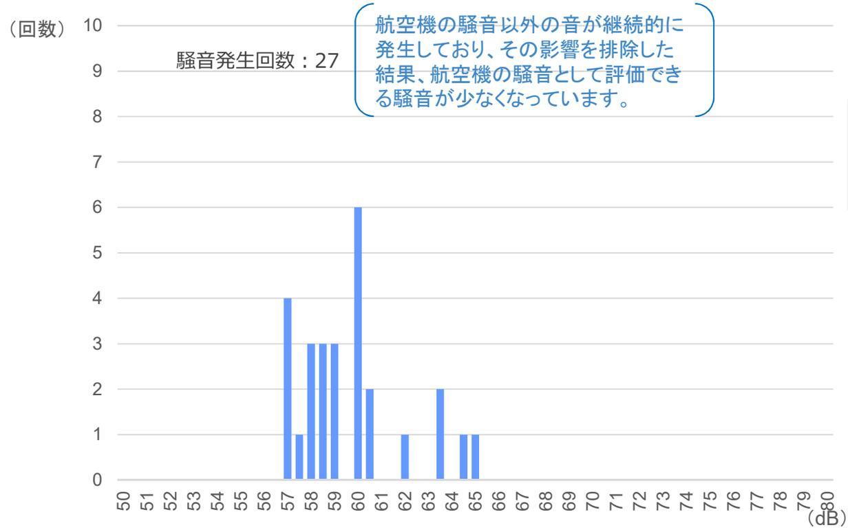
機体サイズ (大・中・小型機) を区別せず算出した実測値の平均 **60.5dB**
