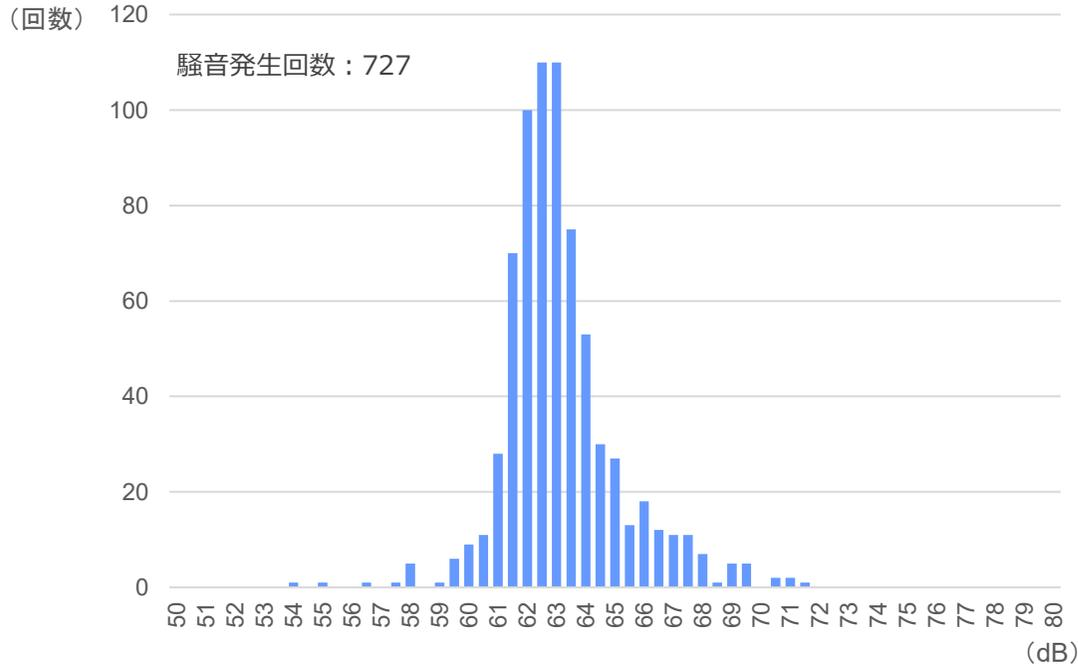
機体サイズ（大・中・小型機）を区別せず算出した実測値の平均 **63.9dB**
