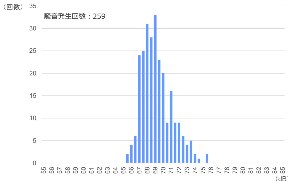
機体サイズ（大・中・小型機）を区別せず算出した実測値の平均 **69.9dB**
