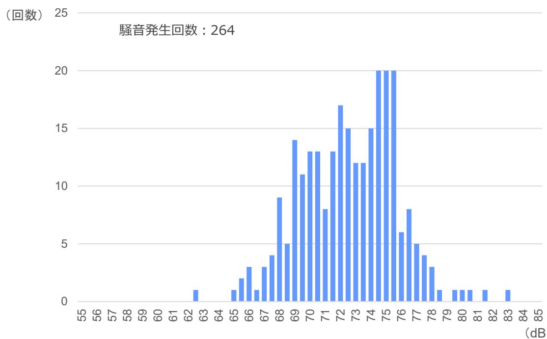
機体サイズ（大・中・小型機）を区別せず算出した実測値の平均 **73.9dB**
