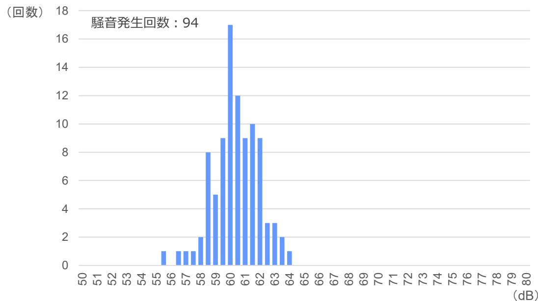
機体サイズ(大・中・小型機)を区別せず算出した実測値の平均 **60.9dB**
