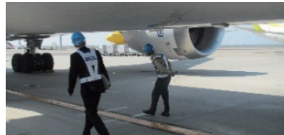
機体の胴体・主翼(エンジン含む)・脚などに部品欠落・着氷等がないか点検
