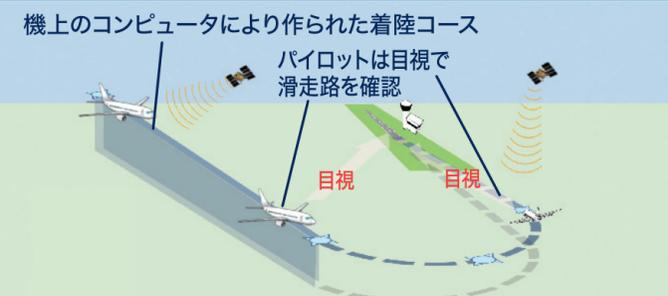
②測位衛星(GPS)を使用して着陸する方式
