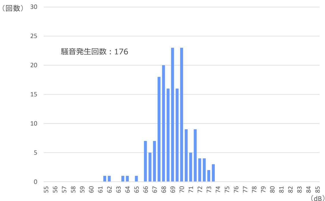
機体サイズ（大・中・小型機）を区別せず算出した実測値の平均 **69.6dB**
