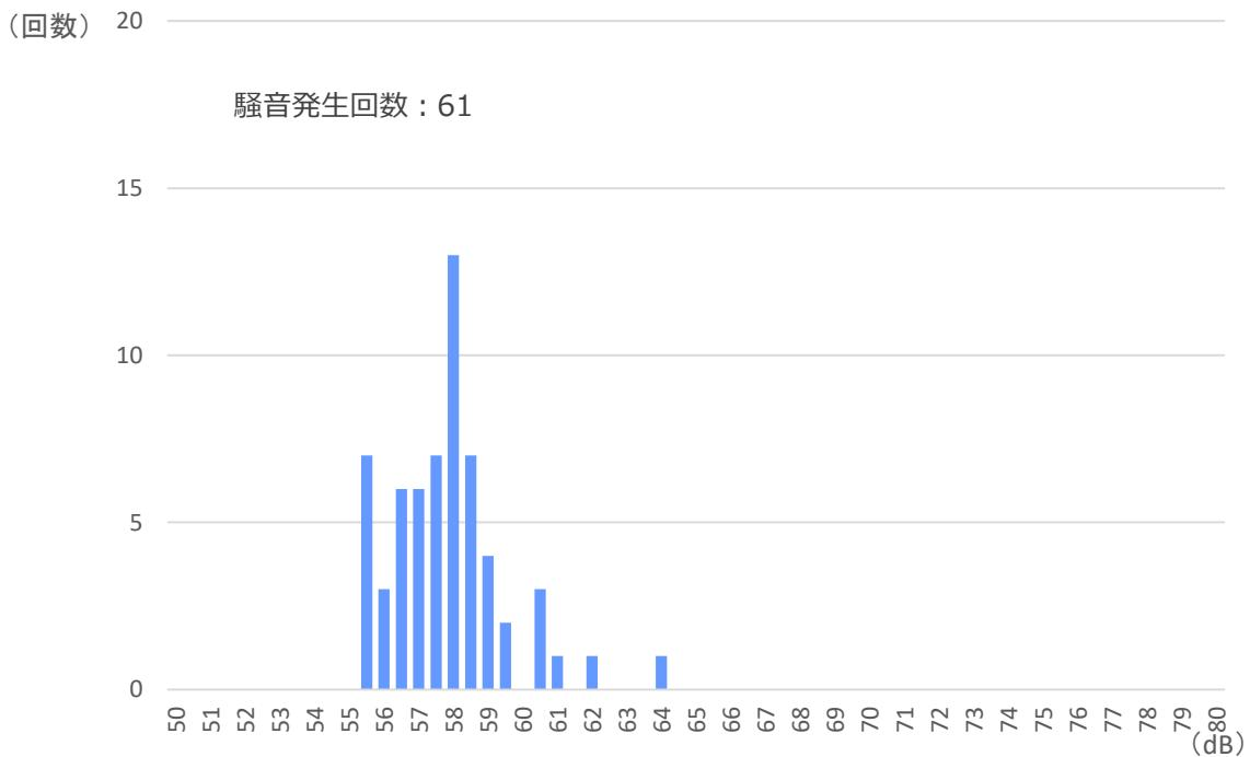
機体サイズ（大・中・小型機）を区別せず算出した実測値の平均 **58.4dB**
