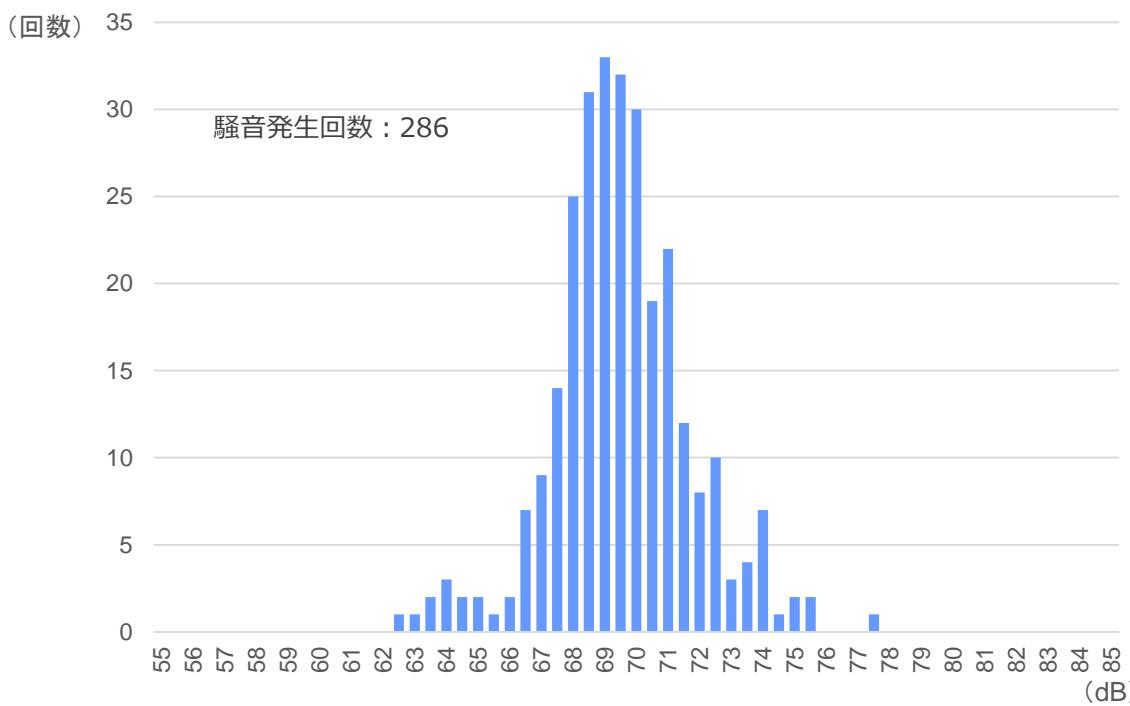
機体サイズ（大・中・小型機）を区別せず算出した実測値の平均 **70.3dB**
