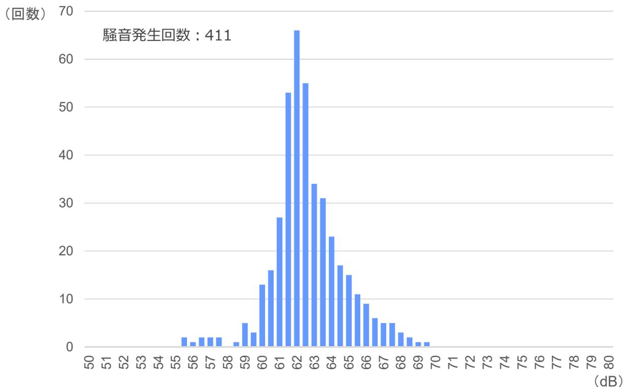
機体サイズ (大・中・小型機) を区別せず算出した実測値の平均 **63.4dB**
