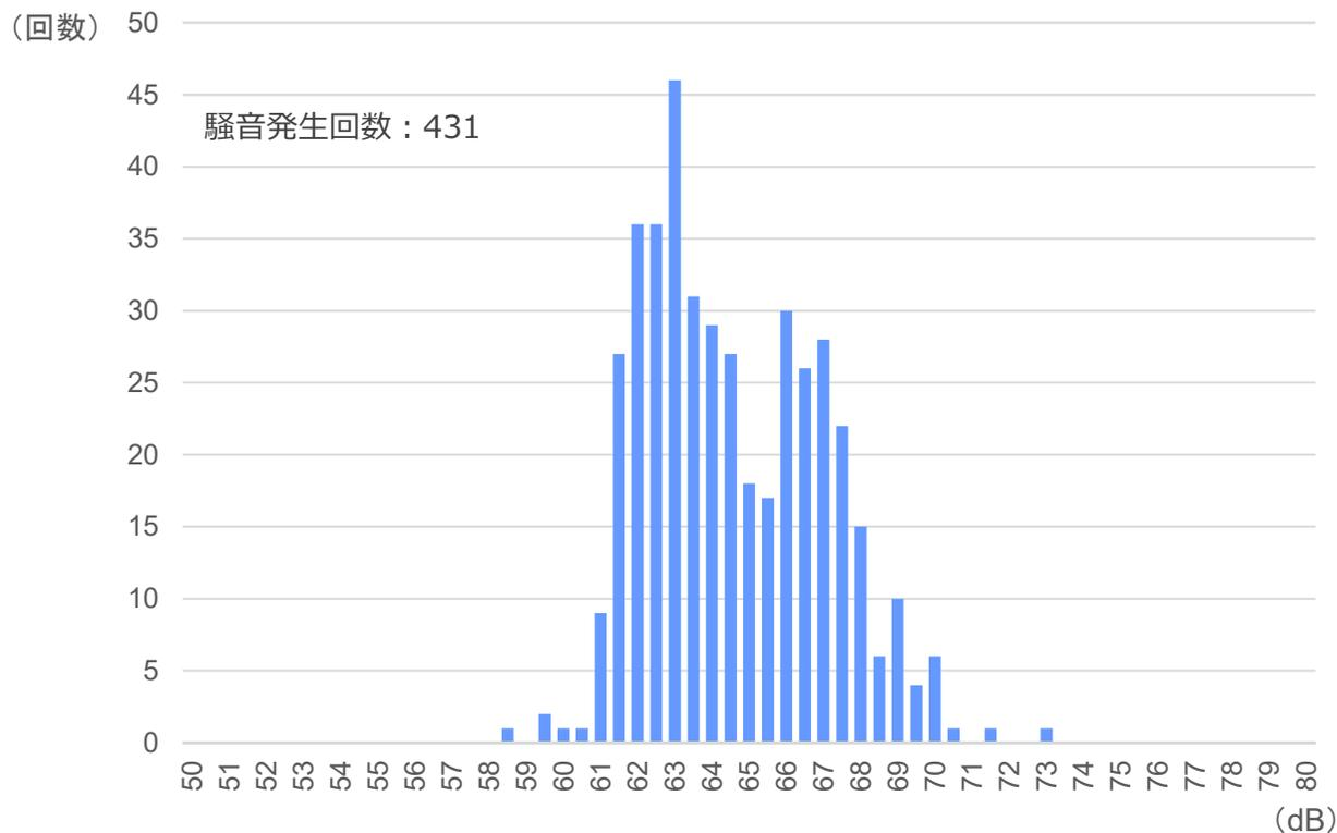
機体サイズ (大・中・小型機) を区別せず算出した実測値の平均 **65.5dB**
