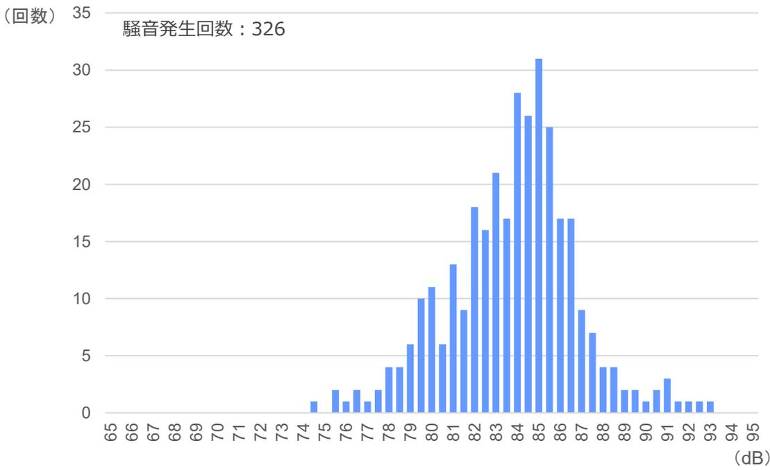
機体サイズ（大・中・小型機）を区別せず算出した実測値の平均 **85.0dB**
