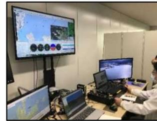
中間飛行は、東京から遠隔操縦。航行船舶、風況等を常時確認しながら、操作（基本はプログラム飛行）
