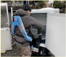
蓄電池をアシストスーツ着用下で搭載する様子
