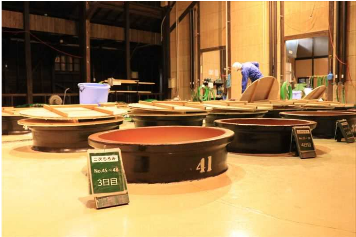
二次仕込みの工程。温度管理をしながら8日~10日ほど発酵させる
